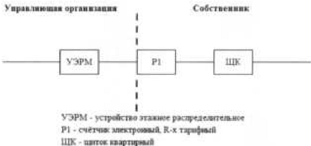
Исполнитель несет ответственность за надлежащее состояние и работоспособность питающих электрических сетей на квартиру согласно изложенной ниже схеме до прибора учета (пунктирной линии слева).
